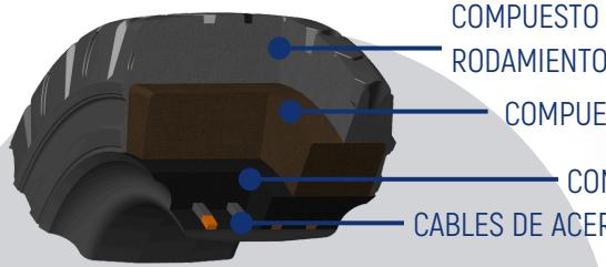
COMPUESTO DE LA BANDA DE RODAMIENTO
